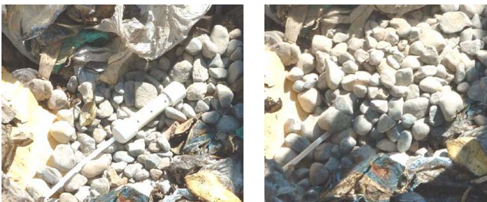
Εικόνα 5. Σύστημα δειγματοληψίας εδαφικού αέρα, πριν (αριστερά) και μετά (δεξιά) την επικάλυψη του με χαλίκι (Zhao et al. , 2003).
