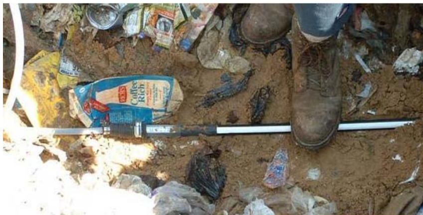
Εικόνα 3. Ηλεκτρόδιο μέτρησης υγρασίας της μεθόδου TDR (Zhao et al. , 2003).
