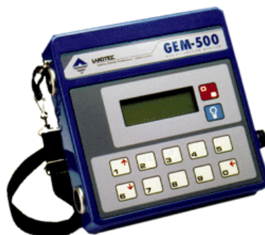
Εικόνα 6. Συσκευή μέτρησης βιοαερίου GEM-500 (Landfill Gas Monitor, 2005).
