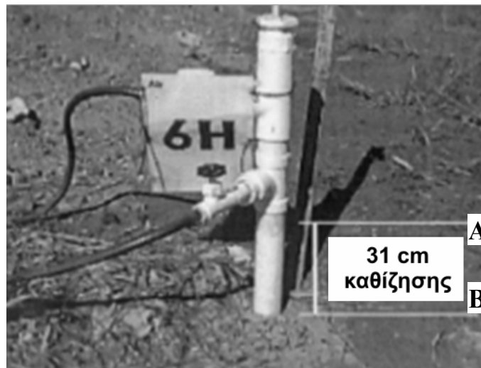
Εικόνα 31. Καθίζηση μετά από την αερόβια επεξεργασία : (A) Ύψος της επιφάνειας του ΧΥΤΑ όταν έγινε η τοποθέτηση του σωλήνα και (B) Νέο ύψος μετά την καθίζηση (Hudgins et al. , 2000).
